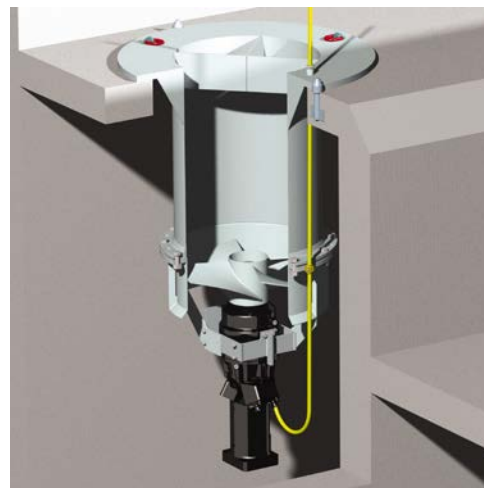
Przykład ustawienia pionowego RZP80-2, tłoczenie w górę. W celu dokonania prac serwisowych z pełnym zbiornikiem, pompę można podnieść razem z całym przewodem tłocznym.
