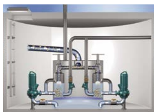
Osiągnięty punkt włączenia pomp
