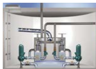
Osiągnięty punkt włączenia pomp
