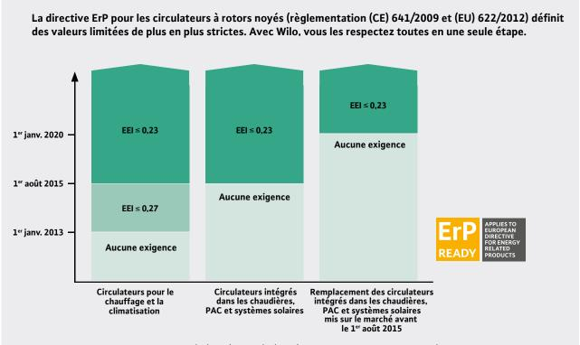
EEI = indice énergie-efficacité selon le règlement (CE) 641/2009 et (UE) 622/2012 de la Commission Européenne (calculé en comparant les différentes puissances absorbées dans un profil de charge avec une pompe de référence à moyenne consommation)
