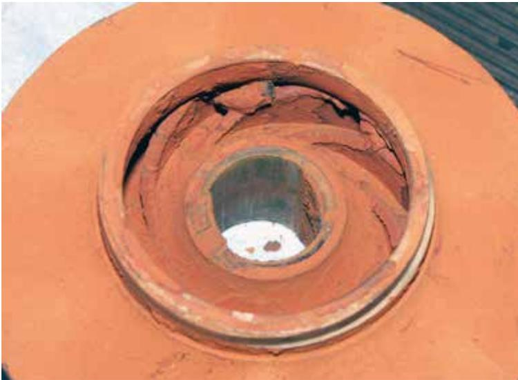
Bild 18: Ablagerungen an den Laufädern von Heizungspumpen
