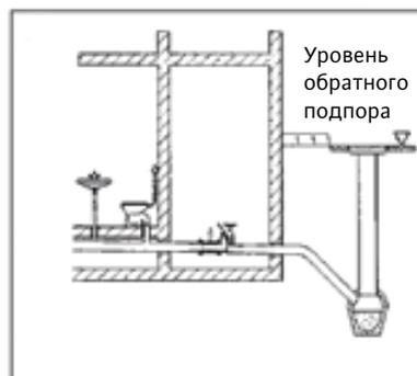
Допускается использование только обратного клапана в технических помещениях, но это не гарантирует 100% защиты от затопления.
