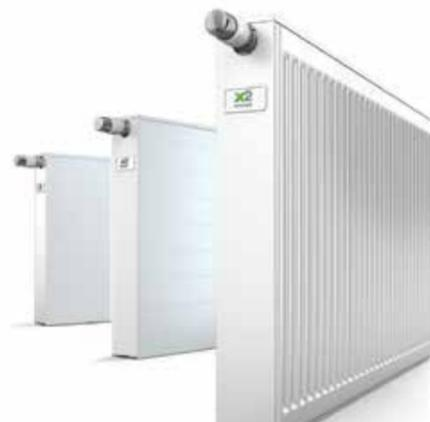
3000 мм, высотой от 200 до 900 мм. Рабочее давление всех радиаторов – 10 бар, испытательное – 15 бар. Все радиаторы (за исключением радиаторов высотой 200 мм) комплектуются настенными кронштейнами, поэтому готовы к монтажу. Гарантия производителя составляет 10 лет. Кроме стальных панельных радиаторов Kermit предлагает широкую линейку дизайн-радиаторов и полотенцесушителей для ванных комнат в электрическом исполнении.
