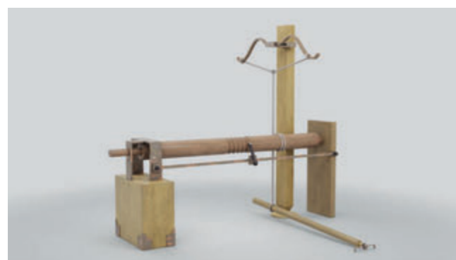
Резьбонарезной копировальный токарный станок с приводом от оцепы, автор Леонардо да Винчи 1500 год
