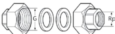
**Резьбовое соединение для циркуляционных насосов**
