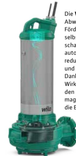
Die Wilo-Rexa SOLID-Q ist eine Abwasser-Tauchmotorpumpe zur Förderung von Roh-Abwasser. Ihre selbstreinigenden Hydraulikeigenschaften in Verbindung mit den automatischen Reinigungszyklen reduzieren den Serviceaufwand und erhöhen die Betriebssicherheit. Dank ihres hohen hydraulischen Wirkungsgrades in Verbindung mit den Hocheffizienz-Permanentmagnetmotoren senkt das System die Energiekosten erheblich.
