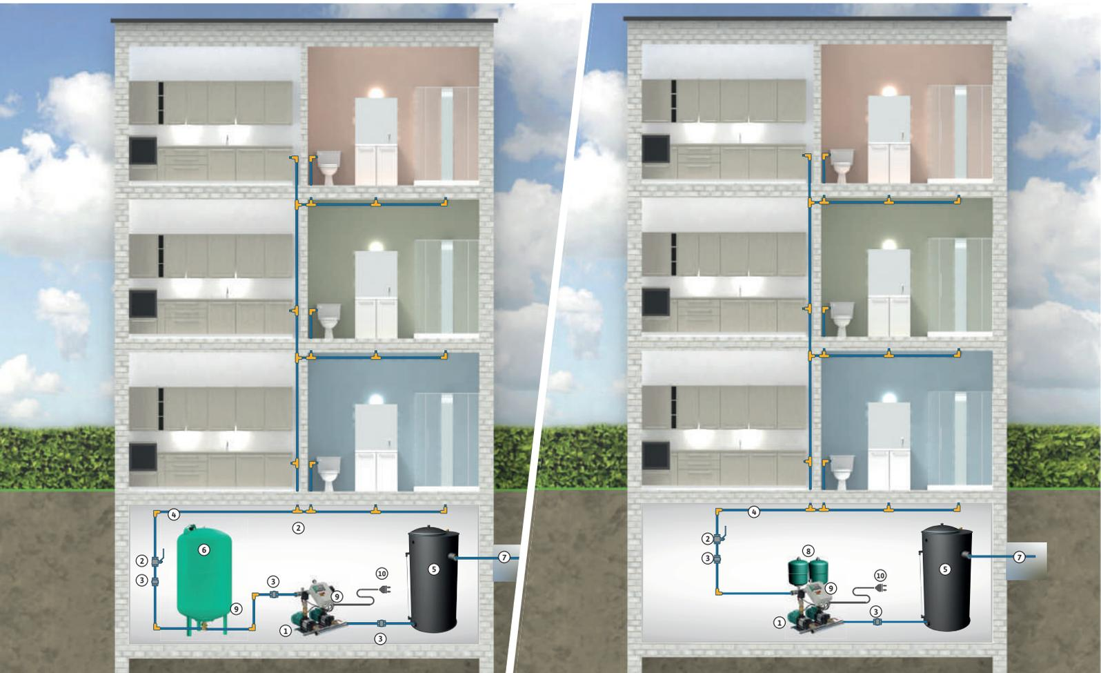
» PRESSURIZZAZIONE DA SERBATOIO PREAUTOCLAVE O RISERVA IDRICA.
