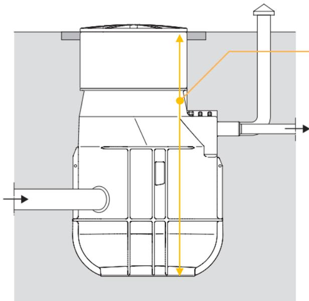
Si le module est placé dans le sol, il a une profondeur maximale de 1,3 m.
