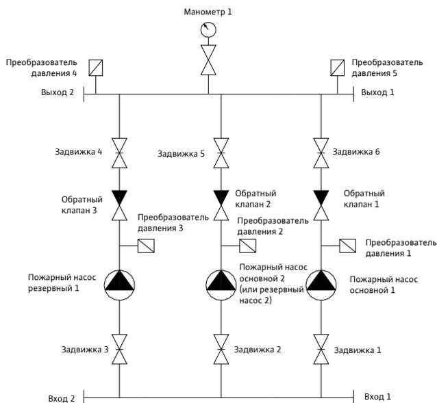
Рис. 4 Гидравлическая схема установки пожаротушения с 3 насосами без разделительных задвижек на коллекторах (2 рабочих, 1 резервный или 1 рабочий, 2 резервных)
