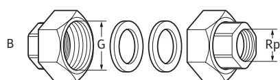
Fig. A : Pièces d'insertions spéciales avec filet mâle Whitworth (DIN EN 10226-1) et alésage intérieur pour le raccordement au choix sur filetage ou par brasure sur le tube en cuivre (DIN EN 1057)
