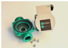
Ble igjen etter pumpebytte, pumpehus 130 mm, ansl. DN 25, drivside Varios PICO STG 15/1-7
