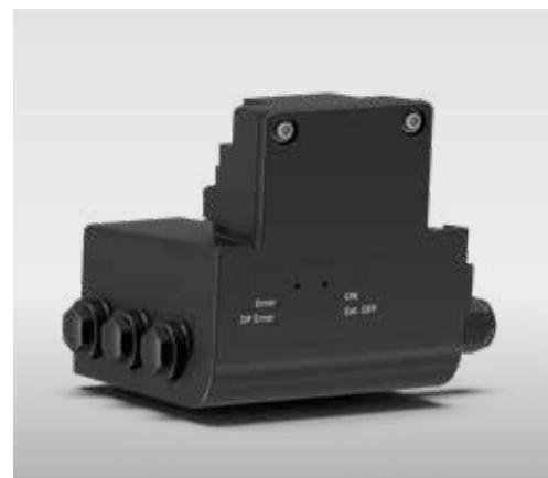
Module enfichable et adaptable pour information de marche SBM, commande d'entrée de désactivation (Ext.Off) pour une connexion à l'automatisation du bâtiment.
