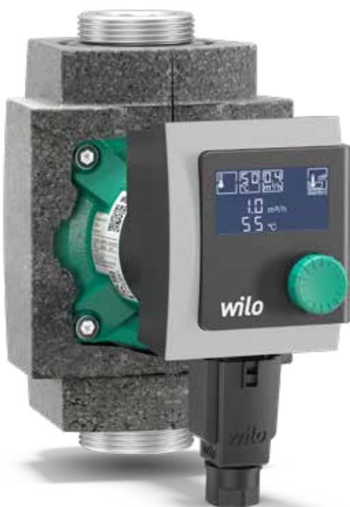
Grâce à l'installation et à la mise en service aisées, le système de circulation d'eau chaude sanitaire de la maison est rapidement et efficacement protégé contre les légionelles. Le circulateur à haut rendement premium Wilo-Stratos PICO-Z prend en charge automatiquement la désinfection thermique du réservoir d'eau chaude sanitaire. Une température réglée à 55 °C minimum permet de réduire le risque de formation de germes dans le système de circulation.
