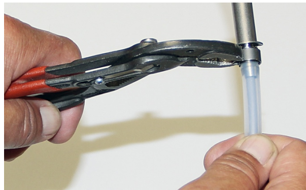
6. Die Schlauchschelle wird dann mit einer geeigneten Zange verquetscht.
