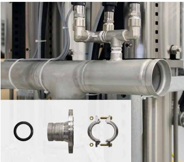
1. Flansch und Kupplung liegen der Trennstation bei.
