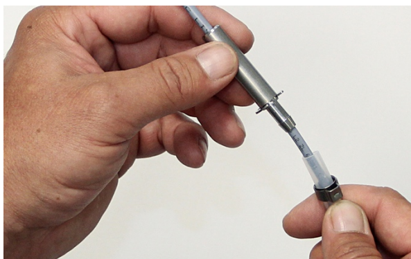
4. Das Edelstahlrohr wird so aufgeschoben, dass die Schlauchtülle zum Schlauch zeigt.
