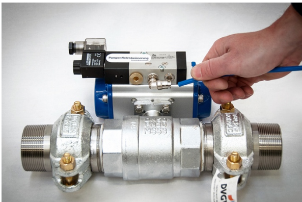
1. Der mitgelieferte Druckluffterzeuger wird mittels Steckverbindung mit der Trennstation verbunden.
