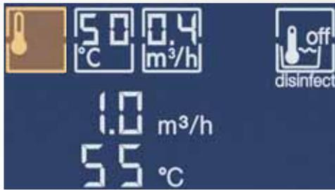
Il numero di giri viene regolato in funzione della temperatura dell'acqua in modo tale da mantenere la temperatura del fluido di ritorno al di sopra della temperatura impostata.
