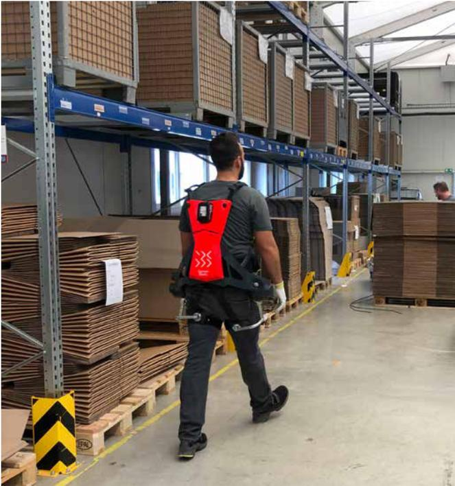
Ergonomische Unterstützung durch Smart Exoskeleton
