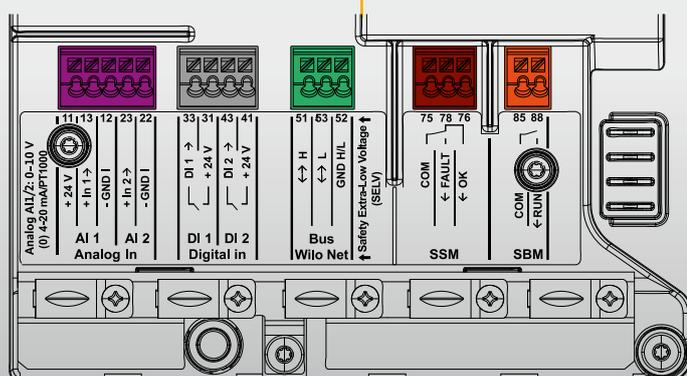
Le repérage couleur des bornes et la séparation claire des raccordements électriques et de communication (SELV) garantissent une organisation simple et sécurisée
