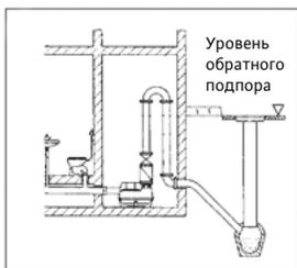
Использование петли защищает от затопления и обратных потоков.
