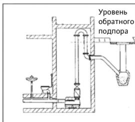
Отвод стоков возможен только при помощи напорной канализационной установки
