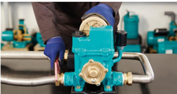
2 Снять насос с установочного места
