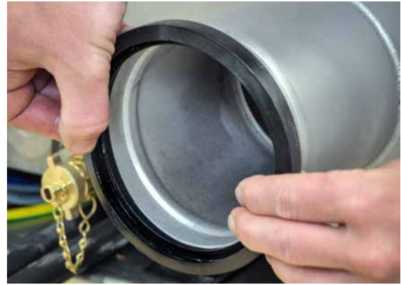
Dichtung auf Saugstutzen montieren.
