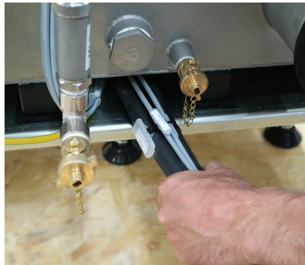
Kabelstrang mittig unter Behälter führen.
