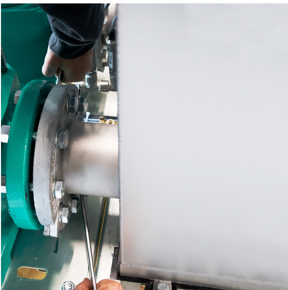
Montage unterhalb des Flansches mit Ratsche.
