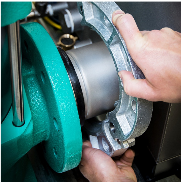
Anordnung Klappflansch auf Stutzen.
