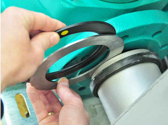
Anordnung Gummiflanschdichtung und Beilagscheibe.
