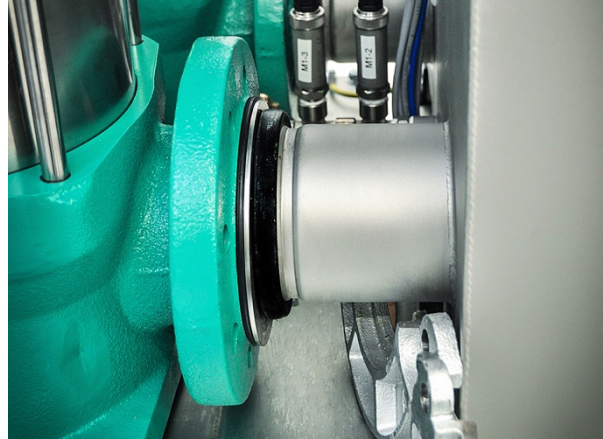
Pumpen- und Behältersegment in Endzustand schieben.
