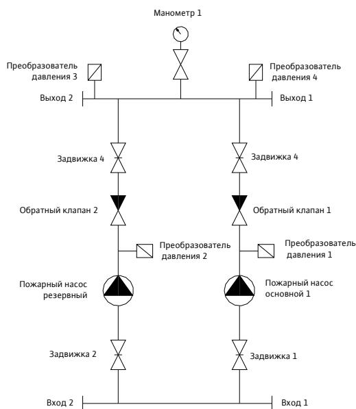
Рис. 3 Гидравлическая схема установки пожаротушения
