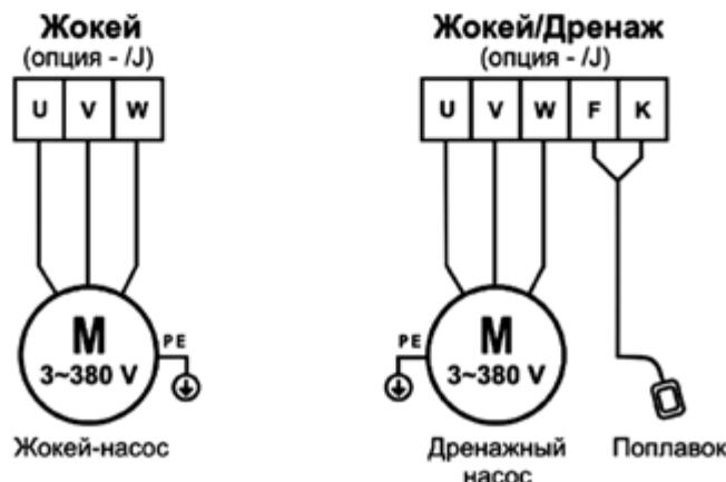
Рис. 6 Схема подключения силовых цепей прибора.
