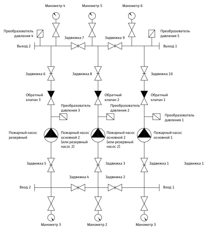
Рис. 2 Гидравлическая схема установки пожаротушения
