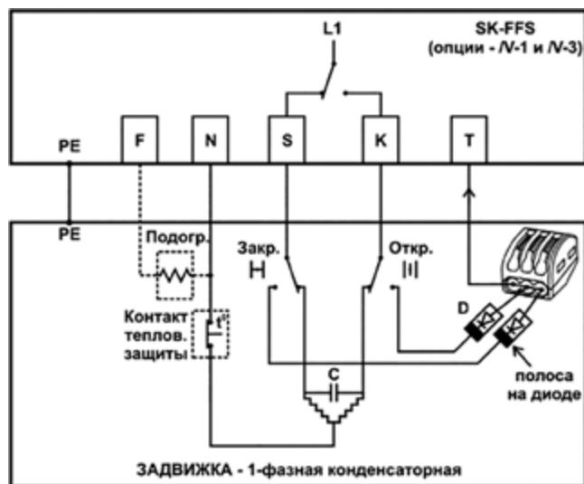
Подогреватель и контакт тепловой защиты подключаются при наличии.
