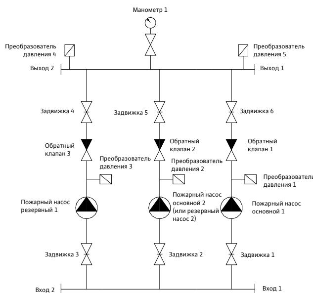
Рис. 4 Гидравлическая схема установки пожаротушения
