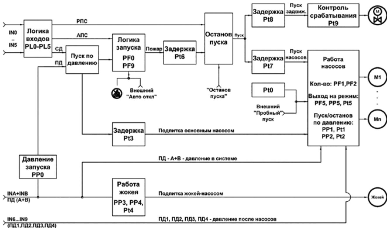
Указанные на схеме параметры задаются при вводе оборудования в эксплуатацию
