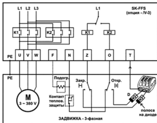
Подогреватель и контакт тепловой защиты подключаются при наличии.
