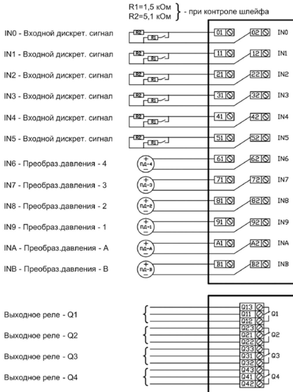
Рис. 7 Схема подключения сигнальных цепей прибора.
