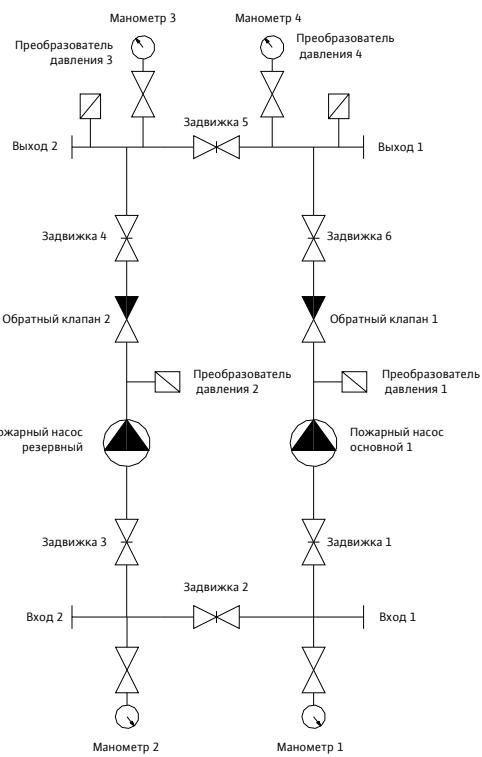
Рис. 1 Гидравлическая схема установки пожаротушения
