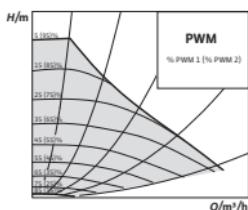
PWM 信号生成器向水泵发送符合 DIN IEC 60469-1 标准的周期性脉冲序列（占空率）。
