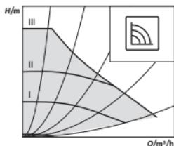
水泵以预设的三个固定转速挡位 (I, II, III) 运转。
