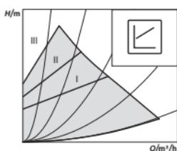
管网内体积流量减小时，水泵将扬程减小一半。
