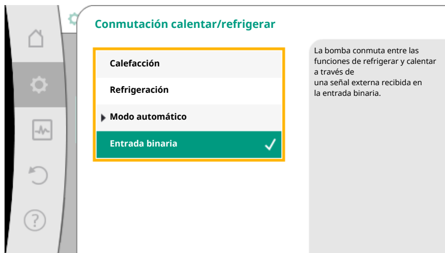
Fig. 58: Conmutación calentar/refrigerar_Entrada binaria
