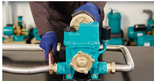
**2** Снять насос с установочного места
