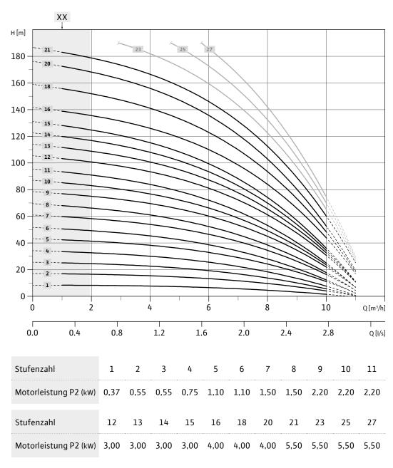
Im Diagramm werden die Pumpenkennlinien der Hochdruck-Kreiselpumpen dargestellt. Für das System sind zusätzliche Druckverluste von 0,5 bar bei der Auslegung zu berücksichtigen.
