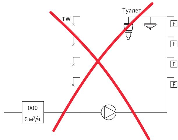
Пример настройки неправильной противопожарной защиты и установки пожаротушения с прямым подключением к сети PW без разделения системы, с помощью, так называемой точки отбора «alibi».
