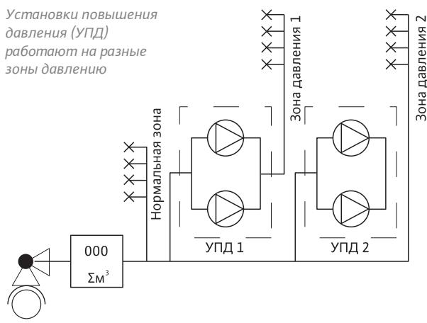
Нижние этажи обеспечены водой за счет давления от общественного водоснабжения. На каждую следующую зону вода подается при помощи отдельной установки повышения давления (УПД). Зоны давления могут быть объединены, так чтобы вода на каждую зону подавалась при помощи одной установки повышения давления.
