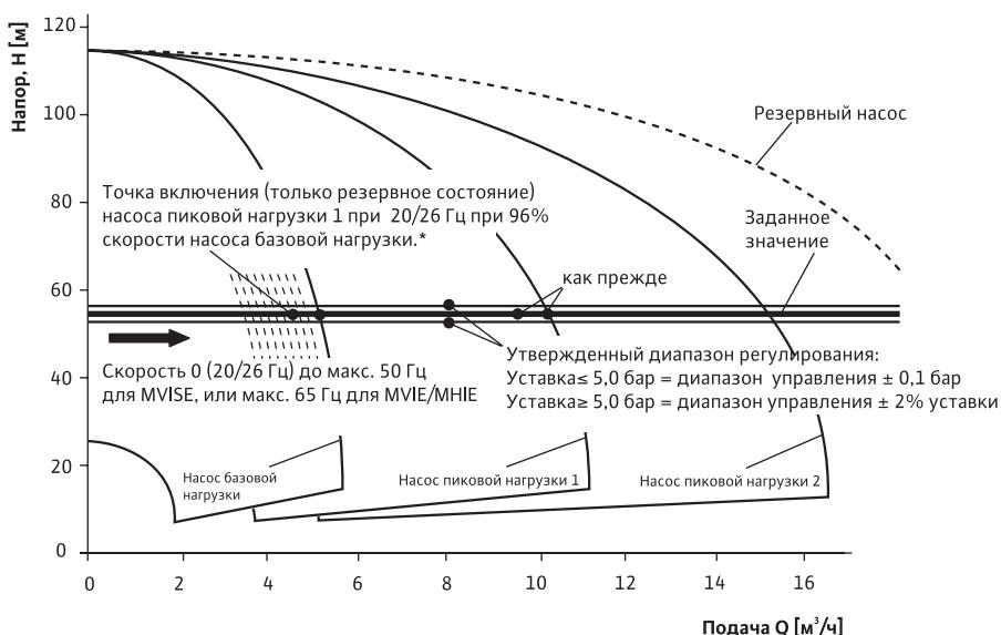
\* Если насос базовой нагрузки остается на этой скорости, то отключение насоса пиковой нагрузки наступает через 15 секунд
