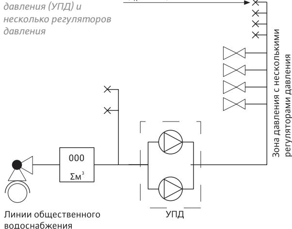
Нижние этажи обеспечены водой за счет давления от общественного водоснабжения. На более высокие этажи здания, вода подается установкой повышения давления, при этом некоторые зоны (ближайшие в УПД) защищены с помощью регуляторов давления. На последнюю зону (верхние этажи здания) вода подается непосредственно при помощи установки повышения давления.
