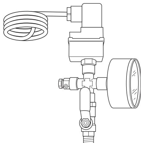
Реле защиты по сухому ходу для прямого подключения, состоит из реле давления, манометра, крана
