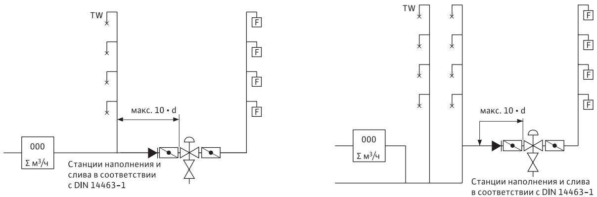
Пример системы с водонаполненным/сухотрубным стояком с установкой наполнения и слива с максимальной длиной подводящего участка трубы для предотвращения микробного загрязнения.
