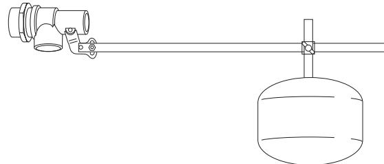
Поплавковый клапан используется для контроля уровня в открытых буферных емкостях (предварительных) с полезным объемом до 1000 л. Поплавковый клапан R 1/2 как клапан управления применяется в сочетании с мембранным клапаном
