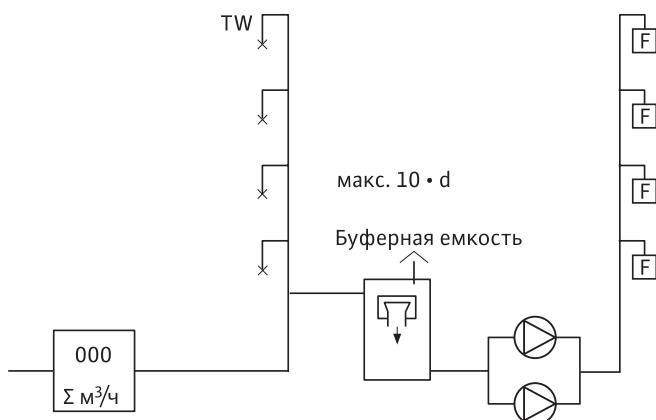
Максимальная длина линии подачи без устройства промывки 10 DN до ВТ системы пожаротушения и противопожарной защиты
