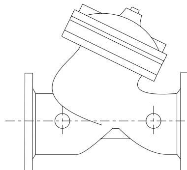
Мембранный клапан используется для контроля уровня в открытых буферных емкостях (предварительных резервуарах) начиная с 1500 л полезного объема в сочетании с поплавковым клапаном R 1/2 в качестве клапана управления
