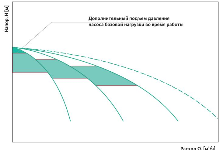
Прежняя каскадная активация, но контролируемая. Система без контроля скорости, которая контролирует время выработки насоса базовой нагрузки. Надежная система с передачей функций базовой и пиковой нагрузки, но с широким диапазоном  $\Delta p$ . Из-за времени выбега, отключающее давление насоса базовой нагрузки всегда то же, что и нулевой напор подачи насоса ( $H_{\max}$  насоса при  $Q = 0$ ).
