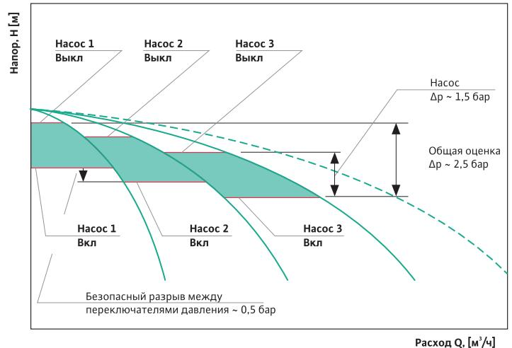
Каскадное управлением насосами в установке повышения давления обеспечивает задержку выключения базового (первого) насоса для предотвращения вибраций. Отключающее значение давления базового насоса соответствует насоса при нулевом расходе ( $Q=0 \text{ м}^3/\text{ч}$ )
