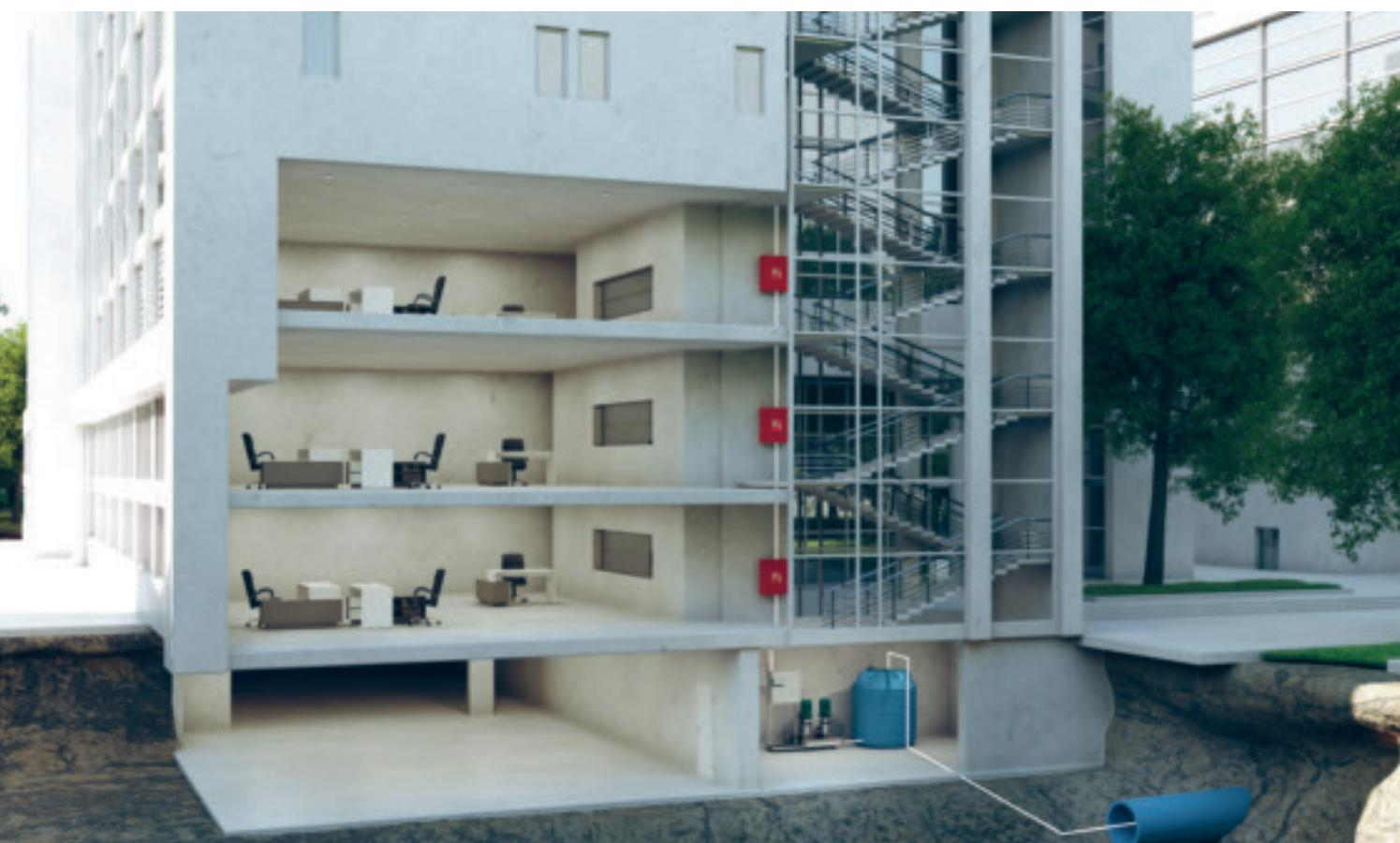
*Центр системы пожаротушения в Берлинской филармонии: Специально разработанная комбинированная система включает в себя небольшой жокей насос, два насоса повышения давления и передатчик давления наряду с резервным передатчиком.*
