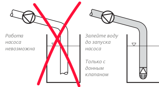
Схема нормальновсасывающего насоса
