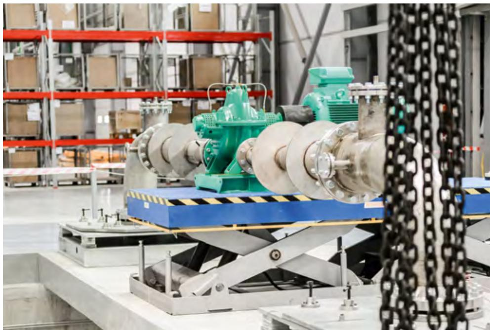
На заводе Wilo в Ногинске установлена 21 сборочная и испытательная линия, 10 испытательных трубопроводов для погружных насосов и испытательный стенд (испытания до 2 МВт), который включает в себя бассейн глубиной 12 м и вмещает до 1000 куб.м.
