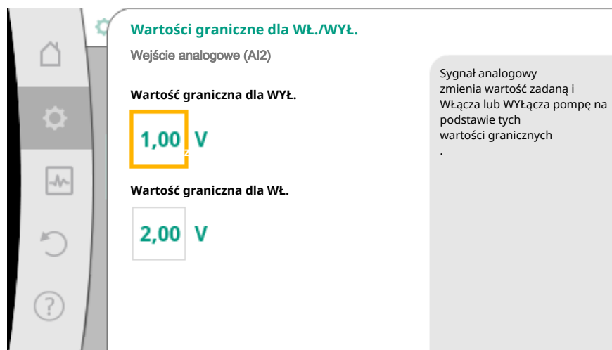
Fig. 73: Wartości graniczne sterowania WŁ./WYŁ. za pomocą sygnałów analogowych Rampa przenoszenia jest teraz zdefiniowana dla transmisji wartości sygnałów analogowych do wartości zadanych. W tym celu określa się minimalne i maksymalne punkty wsparcia charakterystyki pompy oraz związane z nimi wartości zadane (przypisanie sygnału/wartości MIN i przypisanie sygnału/wartości MAX).
