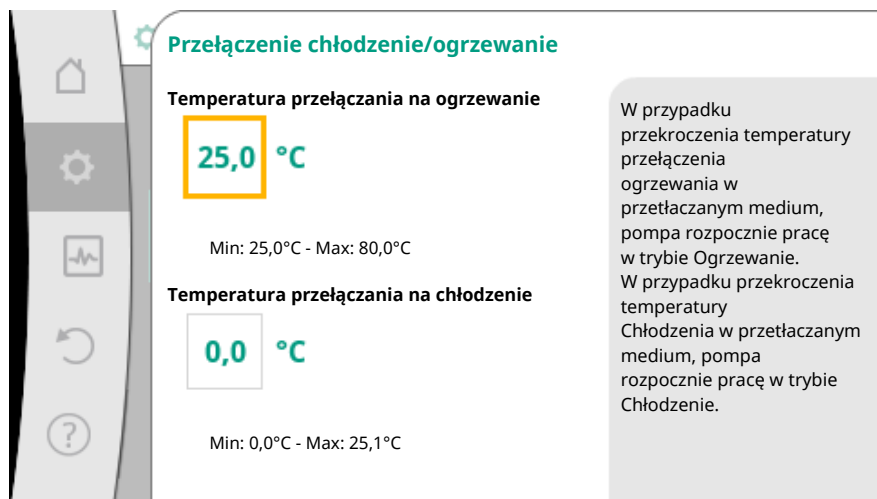
Fig. 56: Przełączenie chłodzenie/ogrzewanie_temperatury przełączenia
