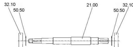
3. Вал в сборе вставить в корпус подшипника со стороны привода в противоположную сторону.
