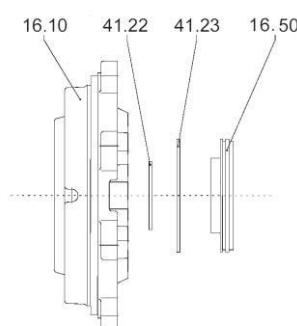
Закрепить крышку 16.50 и крышку корпуса 16.10.
