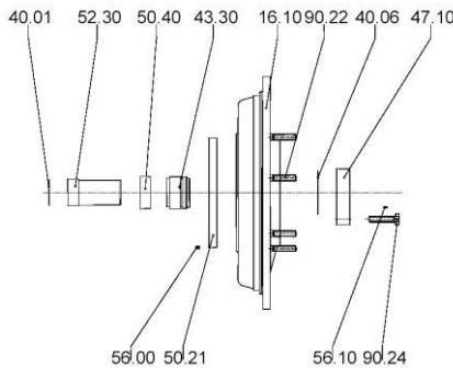
12. Собрать крышку корпуса 16.10 и кронштейн подшипника 33.00. Затянуть гайки 92.02.
