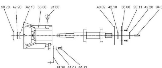
5. Выдвинуть вал с двумя подшипниками 32.10 и распорными кольцами 50.50, если требуется.
