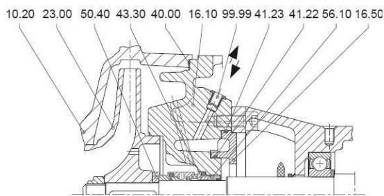
Конструкция с одинарным торцевым уплотнением и внешним охлаждением:
