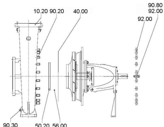
1. Il est possible de marquer la position des différentes pièces entre elles à l'aide d'un marqueur de couleur ou d'une pointe à tracer.
