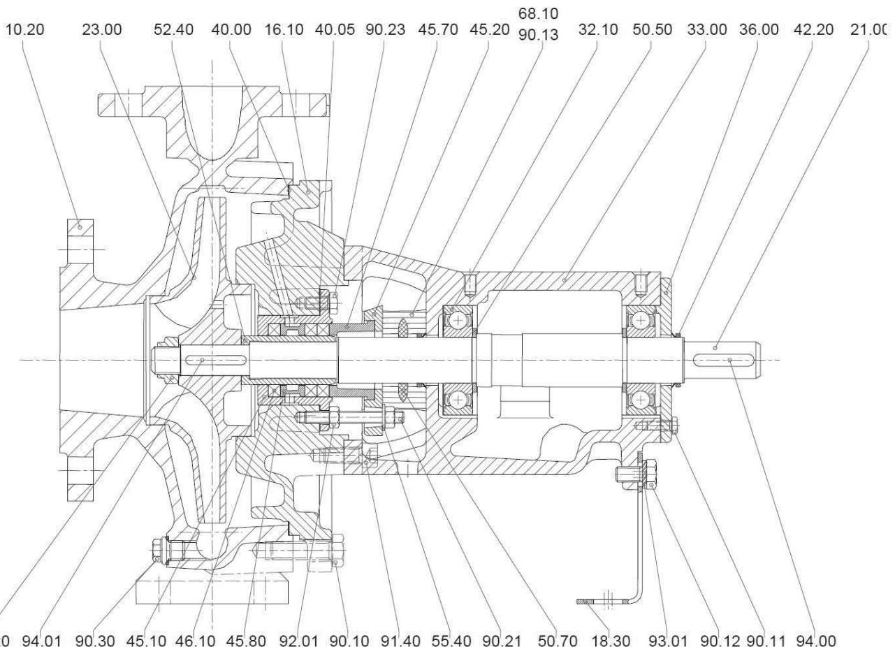
Avec palier à roulements lubrifiés bain d'huile :
