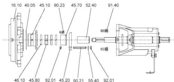
1. Вытащить винты 91.40 и снять крышку корпуса 16.10.
