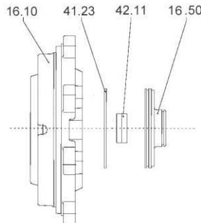
Закрепить крышку 16.50 и крышку корпуса 16.10.
