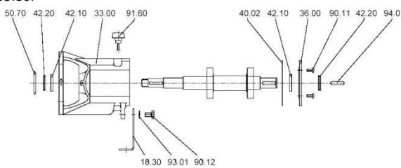
5. Retirer l'arbre complet avec ces deux roulements 32.10 et les entretoises 50.50 si nécessaire.
