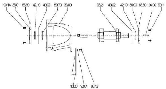
5. Вытянуть вал с двумя подшипниками 32.10 и разделительными кольцами 50.50 и стопорным кольцом 93.21.
