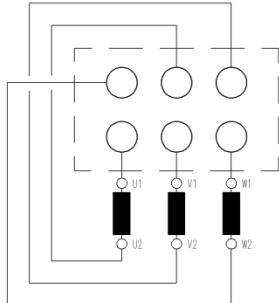
L'inversion du sens de marche de la pompe peut être réalisé directement dans la boîte à bornes du moteur par simple inversion entre deux phases. Le raccordement à la terre est indispensable.
