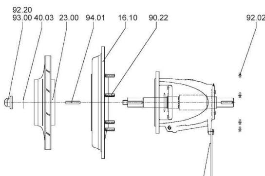
4. Вытащить гайку рабочего колеса 92.20 и ее резьбовую ставку 93.00.
