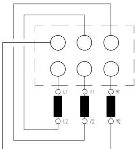
Чтобы изменить направление вращения двигателя, нужно поменять местами две фазы на монтажных зажимах. Подключение заземляющей клеммы является обязательным.
