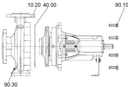
1. С помощью цветной ручки или царапающего инструмента отметить положение частей относительно друг друга.
