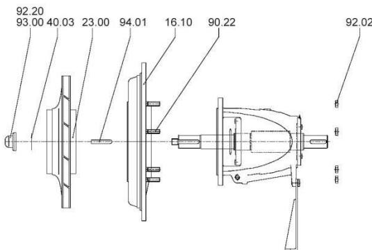
13. Вставить плоскую прокладку 40.01, шпонку 94.01, установить рабочее колесо 23.00 и плоскую прокладку 40.03.
