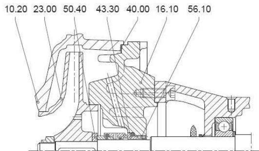
Конструкция с одинарным торцевым уплотнением и подогревом задней крышки:
