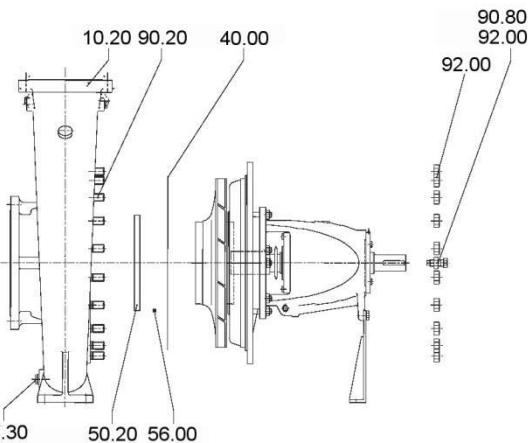
1. С помощью цветной ручки или царапающего инструмента отметить положение частей относительно друг друга
