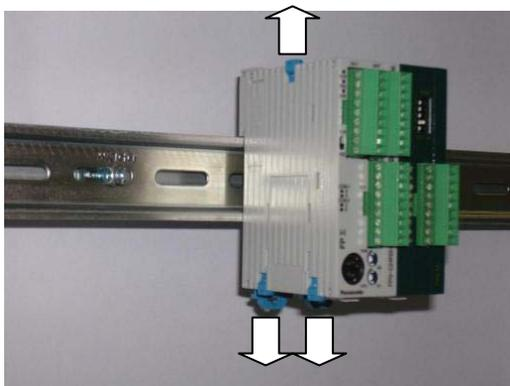
б) Снимите крышку закрывающую разъем с левой стороны установленного PLC контроллера.
