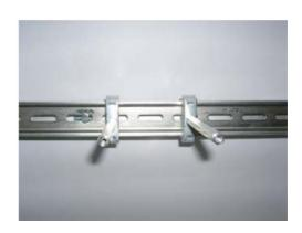
с) Закрепите на опорах монтажную рейку винтами М4х10.
