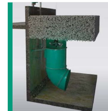
Плавающий слой из носителей биомассы.
