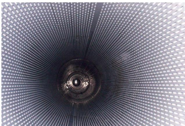
Фильтрующая труба после ремонта
