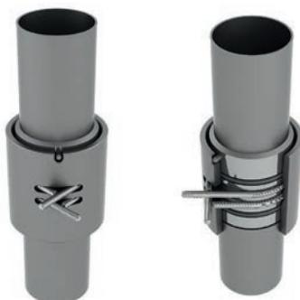
Водоподъемная труба с замковым стыковым соединением (ZSM) позволяет быструю установку, исключая соединения болтами; позволяет иметь меньший диаметр скважины, так как соединения труб с использованием ZSM имеют меньшую толщину, чем фланцевые соединения
