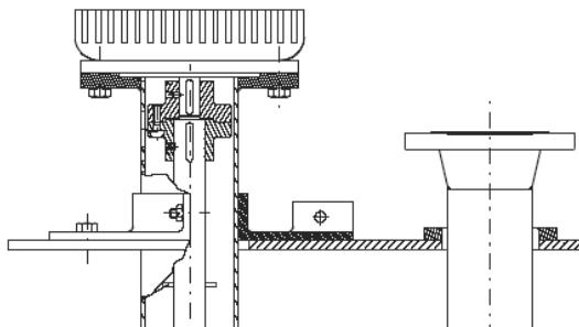
**VEM** : lanterne entretoise entre plan de pose et moteur pour des puissances jusqu'à 18,5 KW. Position de la bride de refoulement non ajustable en hauteur. Accouplement rigide entre arbre moteur et arbre de transmission.
