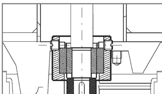
Un second guidage est assuré soit par le palier du moteur dans le cas des constructions CS et EM, soit par un palier à roulements dans le cas de la construction TM.
