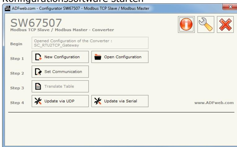
3. Mit „New Configuration“ eine neue Konfiguration anlegen und die Einstellungen wie im folgenden Bild vornehmen
