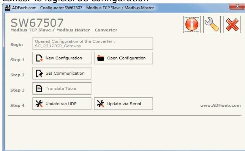
3. Créer une nouvelle configuration avec „New Configuration“ et affecté les paramètres comme sur l'image ci-dessous
