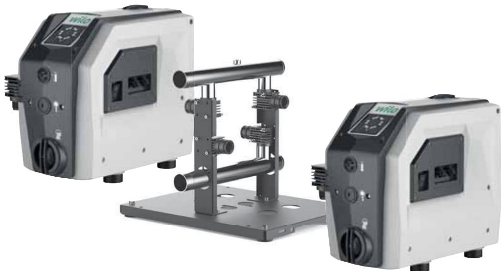
Wilo-Isar BOOST5 prevede la possibilità di essere abbinato ad un altro sistema per una configurazione in modalità Sistema di pressurizzazione con doppia pompa. Il sistema prevede la possibilità di funzionamento in modalità master/slave con una pompa di riserva attiva e in modalità in parallelo con 2 pompe in funzione per una maggiore portata di acqua e quindi un numero maggiore di utenze servite.
