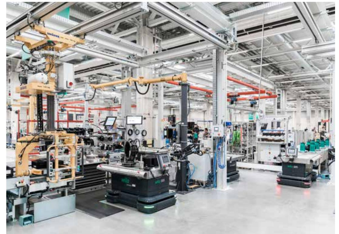
Produktion in der Wilo-Smart Factory. Eingebunden in die intelligenten Prozesse sind auch fahrerlose Transportfahrzeuge, Automated Guided Vehicles (AGV). Sie dienen dem Materialtransport und unterstützen die Produktion.
