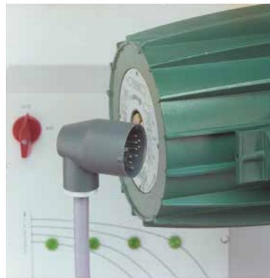
Kommunikationsfähige Pumpe dank Anschluss an einen Schaltkasten
