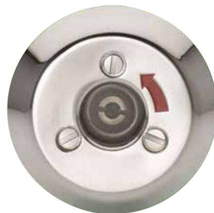
Markenzeichen der Wilo-Perfecta war das Schauglas. Auf der Motoreseite der Pumpe angebracht ermöglichte es einfachste Lauf- und Drehrichtungskontrolle.
