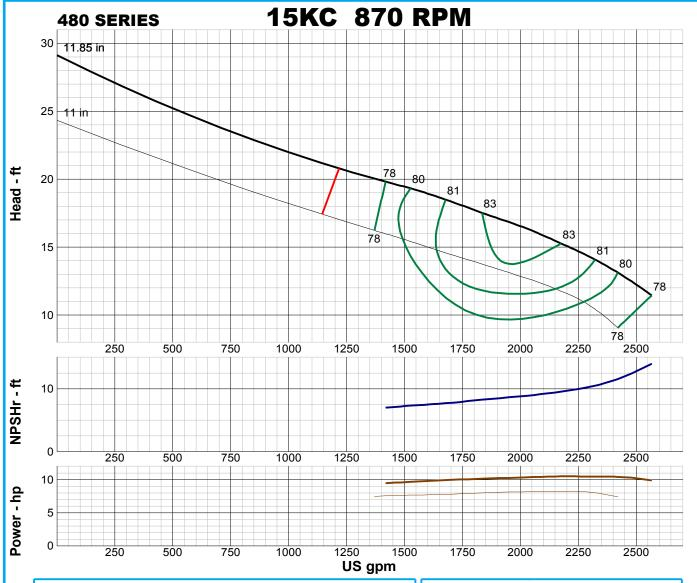
IMPELLER NUMBER0004TYPEENCLOSEDTHRUST FACTORK=28.00EYE AREA63.6 SQ. IN.WEIGHT30.00 LB.
